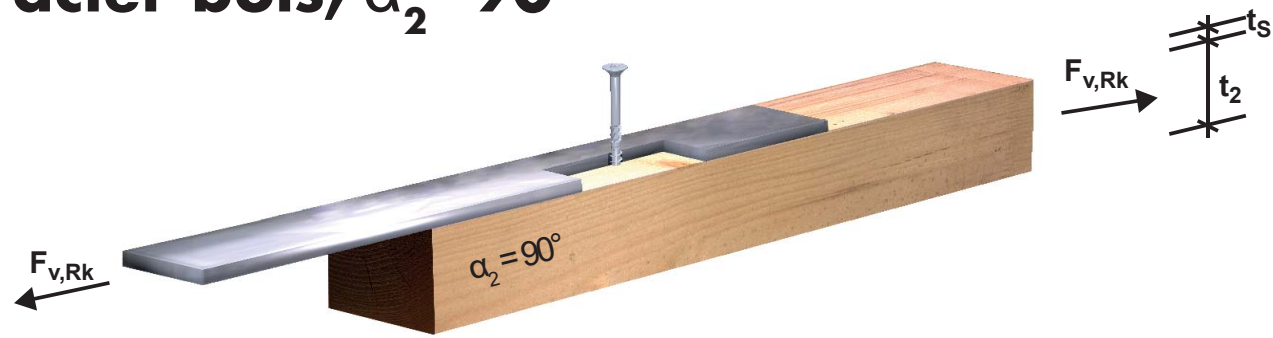
Sollicitation en cisaillement F_{v,Rk} avec F_{v,Rd} longueur de vis minimum requise l_{req}
